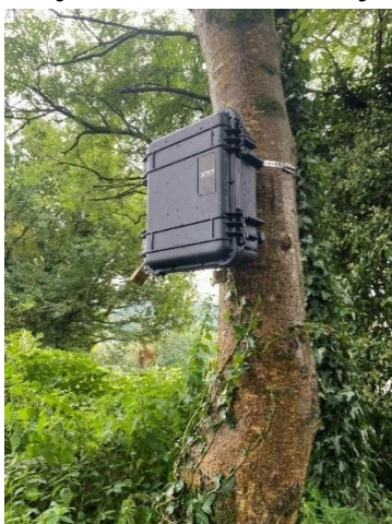
Ffigur 6: Blwch radar yn cofnodi data cerdded a beicio ar NCN43
